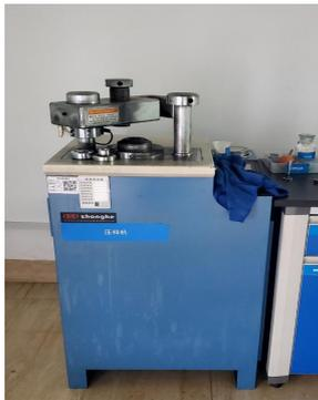
使用自动压片机钢环压片，保持样品致密度稳定、测试面光洁平整。
